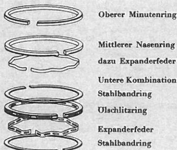
Das **PASSFORM**-Ring-System für einen 3-Nuten-Kolben
